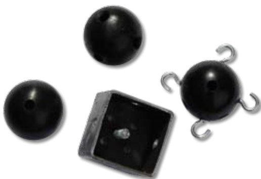
Links die unbearbeitete, rechts die fertige PVC-Kugel mit Bohrshablone
