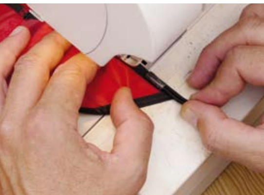
Der Klebestreifen reicht bis an das vordere Saumband, die Schlaufe wird mit den Fingern zusammengedrückt
